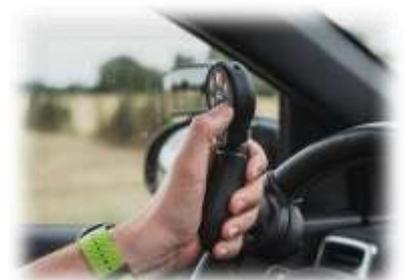
Ce véhicule, équipé de commandes spécifiques, permet également la formation au permis de conduire pour les personnes à mobilité réduite.
